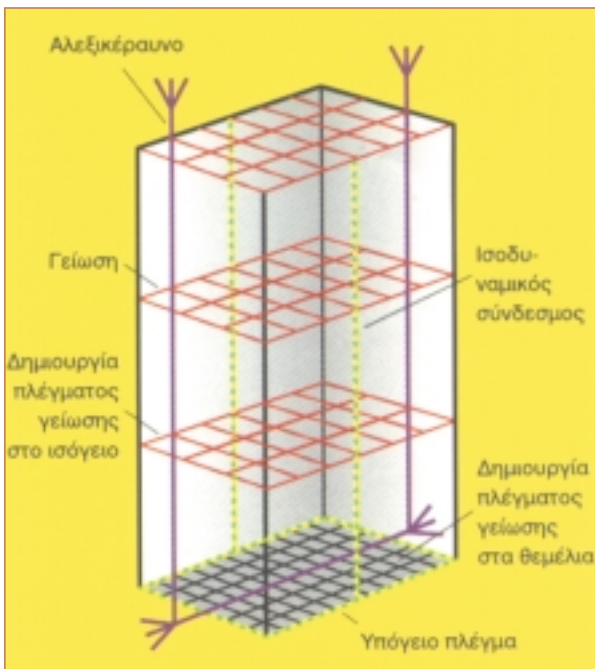
Σχήμα 4.1: Θεμελιακή γείωση σε κτίριο
